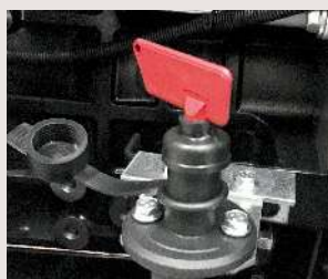
STACCA BATTERIA BATTERY SWITCH
