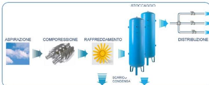
Una parte, ancora rilevante di umidità, non viene condensata e rimane mescolata all'aria compressa allo stato di vapore si sposta lungo le varie tubazioni sino a raggiungere gli stessi utilizzi e/o il prodotto finale.
